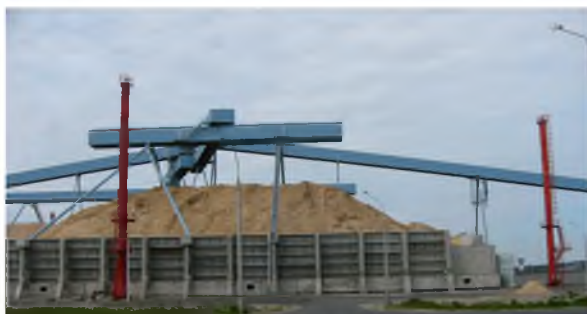
МОНТАЖ ТРАНСПОРТНОЙ ГАЛЕРЕИ ПОДАЧИ ЩЕПЫ НА СКЛАД Адрес: г. Архангельск
